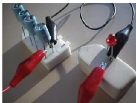
3-5 読みだし係りは、各コンデンサーの端子に読み出し装置の先のみのむしクリップに触れ、LEDが発光したら「1」と記入する。4桁の2進数から元の10進数の数字を当てる。
