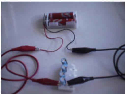
消しゴムに極性に注意しながら発光ダイオードをさし込み、各端子にみのむしクリップ付きリード線をはさみ、これを読み出し装置とする。
