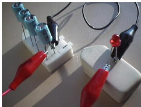
読み出し係りは、各コンデンサーの端子に読み出し装置の先のみの無視クリップに触れ、LEDが発光したら「1」と記入する。4桁の2進数から元の10進数の数字を当てる。
